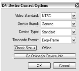
Rysunek 1.4. W oknie dialogowym Device Controls Options określa się standard, markę i typ urządzenia wideo. Kliknij przycisk Check Status , żeby sprawdzić, czy urządzenie komunikuje się z Premiere Pro . Online i Offline oznaczają odpowiednio, że komunikacja została nawiązana, lub jej brak
